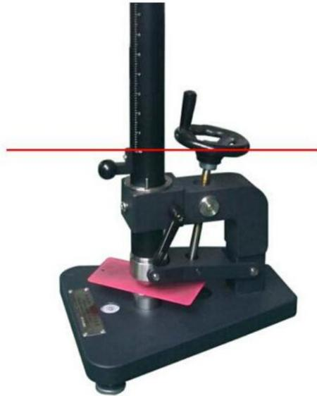
Después de colocar la prueba panel, la parte superior del peso El mango está en la marca cero
